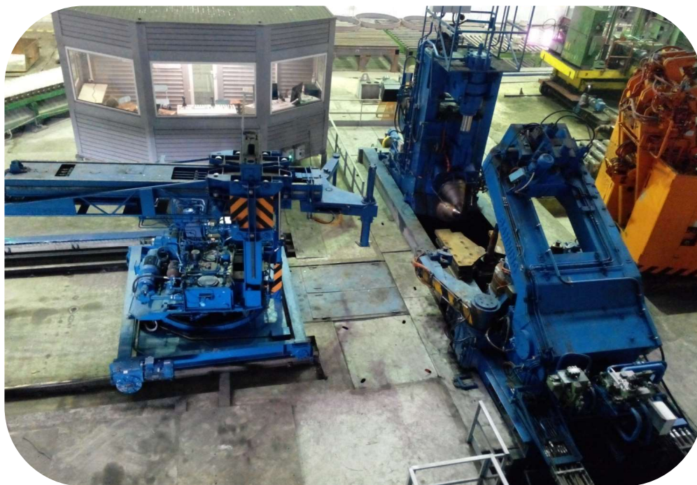
Создание кольцераскатного стана
