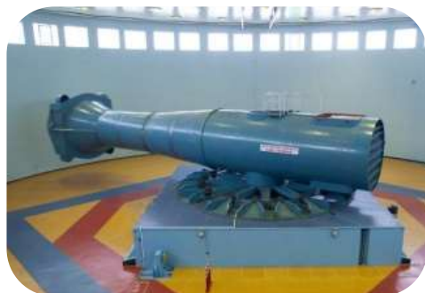
Привод разворота стенда для тренировок космонавтов
