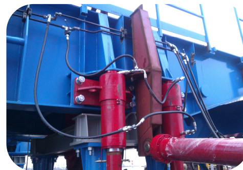
Система перемещения и выравнивания буровой установки
